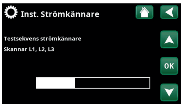
Meny "Avancerat/Inställningar/Strömkännare". Automatkonfigurering av strömkännare.
